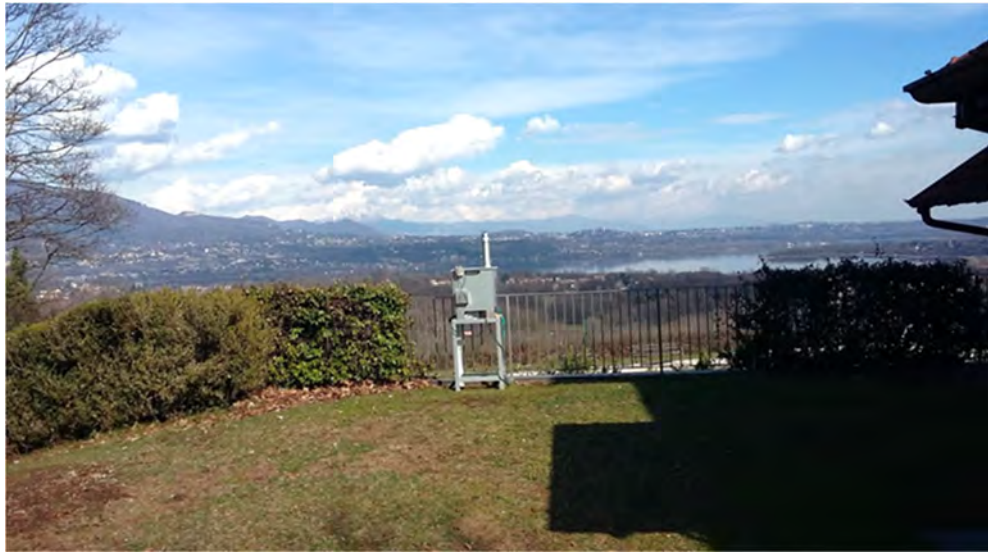
Fig. 1 Centralina sequenziale TECORA SkyPost (loc. Via Monti, Comune di Ternate, 14/03/2018)
